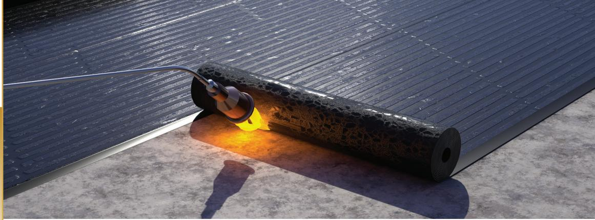
**IKO VAP ALPA 3 en 1** est composé de liant ALPA, d'une armature en voile de verre, d'un film thermofusible en sous-face et de bandes semi-continues de bitume auto-adhésif protégées par un film thermofusible en surface.
