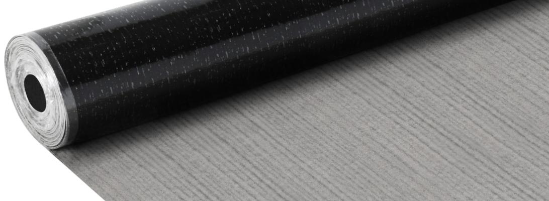
**IKO VAP ALPA 2 EN 1** est un pare-vapeur bitumineux à base de liant ALPA, à armature en voile de verre et muni d'un film thermofusible en sous-face.
