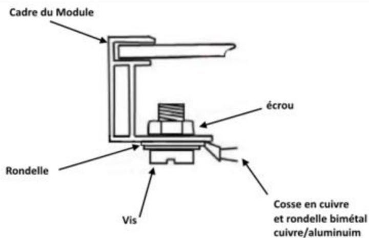
**Figure 24 - Mise à la Terre du module**
