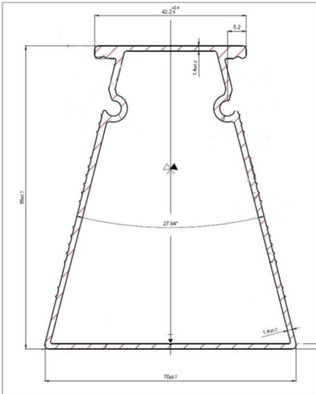
**Figure 6 – Profil trapézoïdal**
