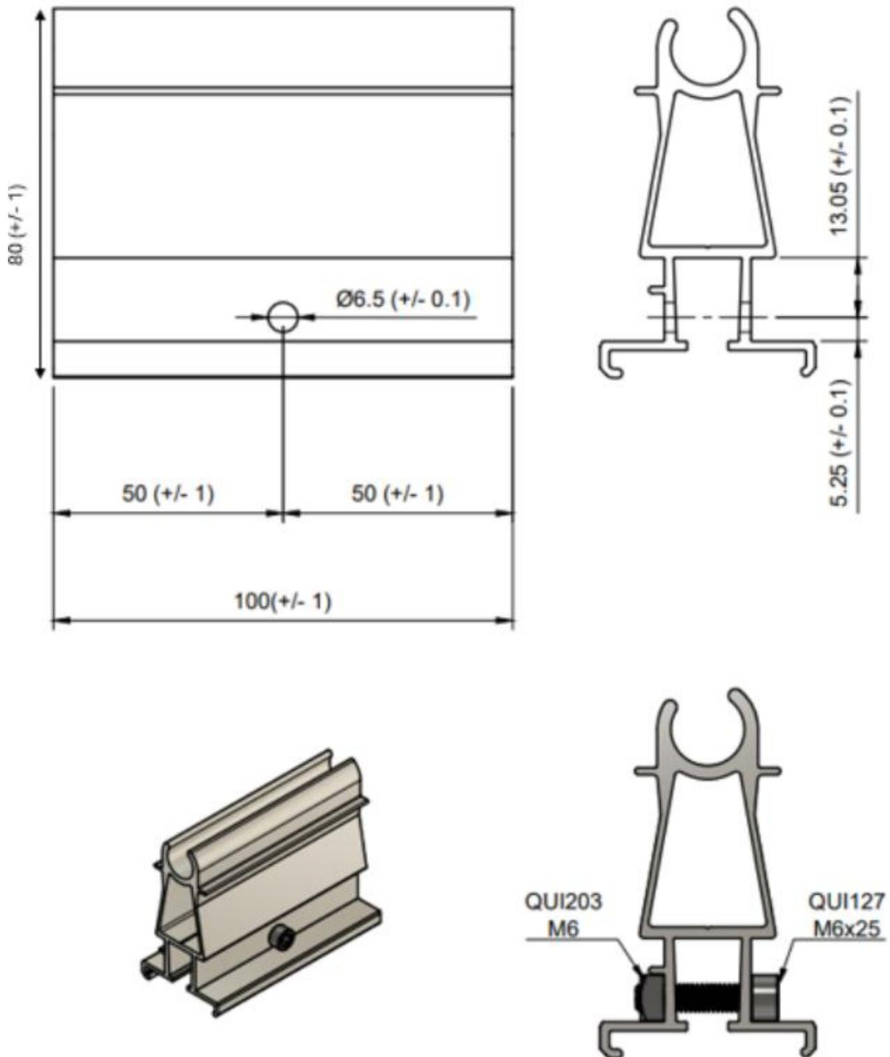
Figure 18 - Support bas du kit d'inclinaison du procédé ROOF-SOLAR BITUME TANDTU – Plat & Incliné
