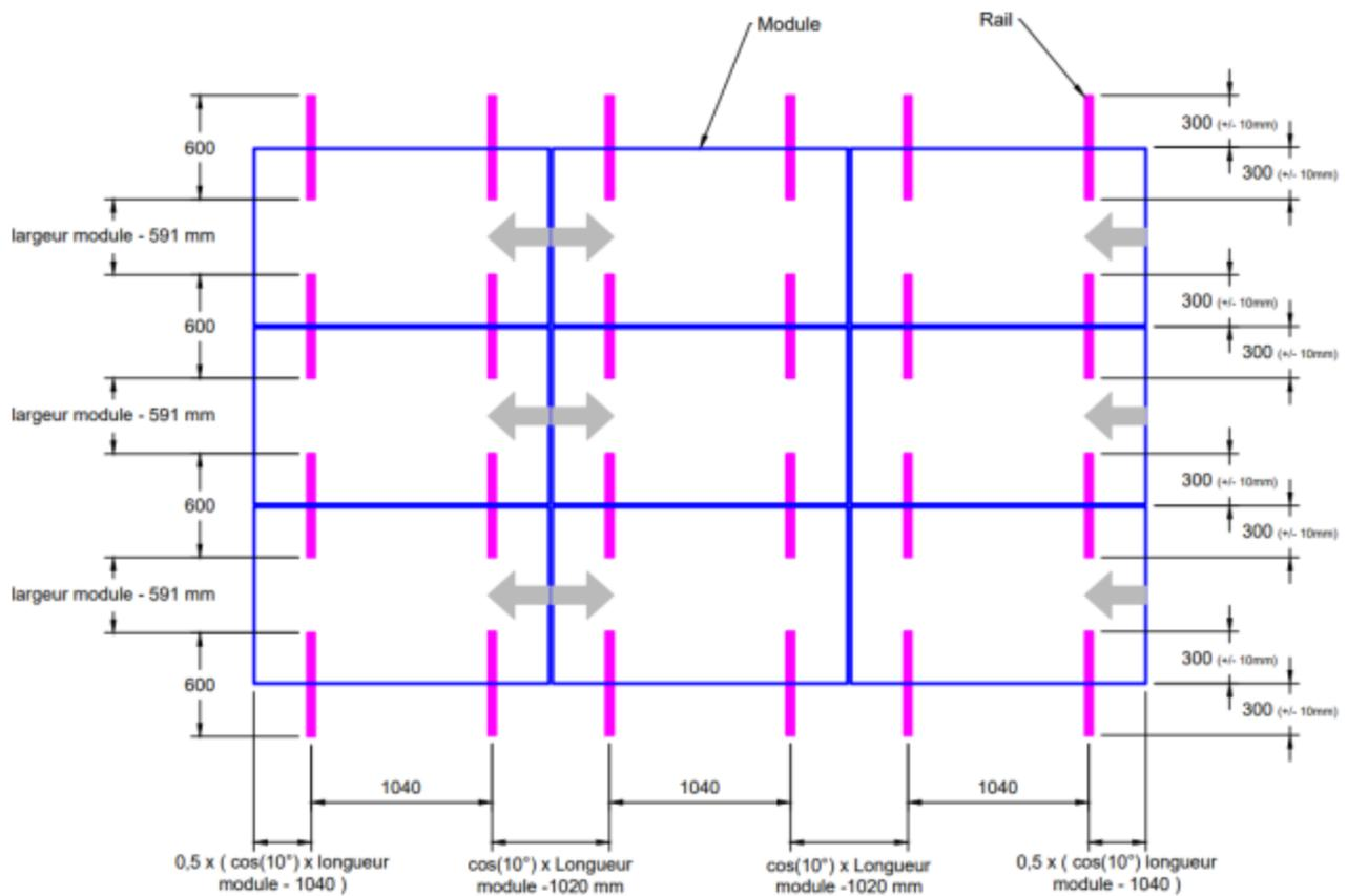
**Figure 36 - Implantation des rails / modules double shed**
